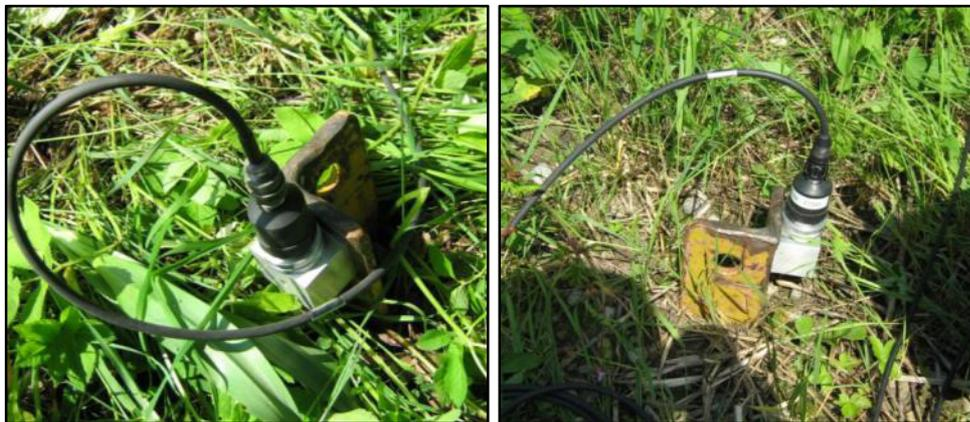
Abbildung 4.3- KS-Aufnehmer MpG7 (z) (links) bei 13m von nächstliegender Gleisachse, MpG4 (z) vorm Haus (rechts)
