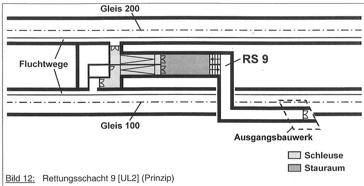
Bild 12: Rettungsschacht 9 [UL2] (Prinzip)
