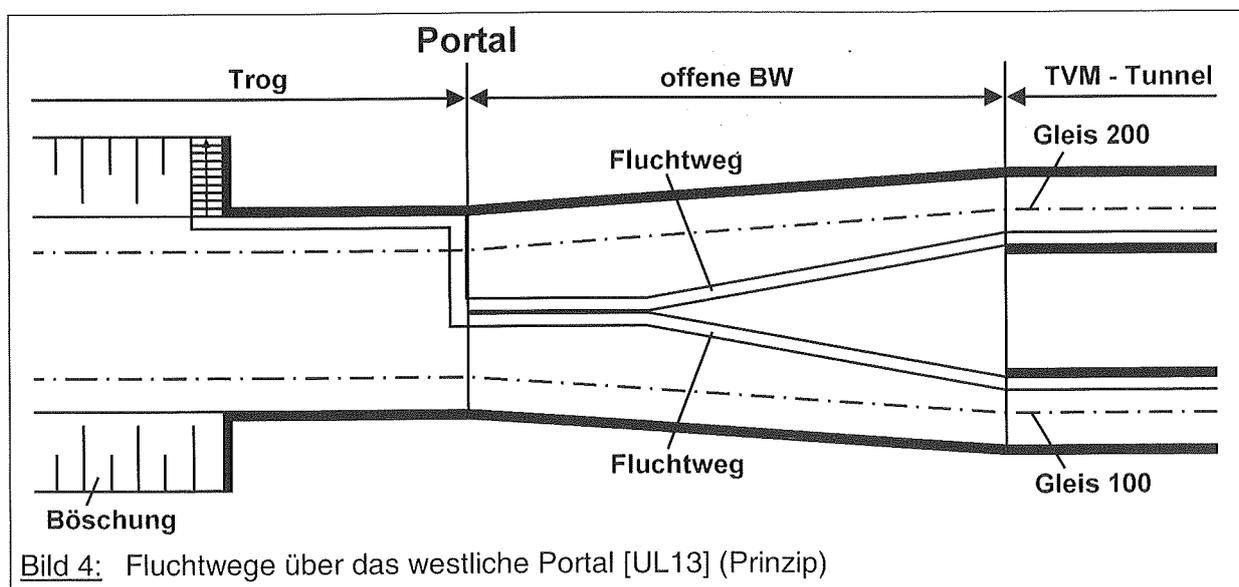
Bild 4: Fluchtwege über das westliche Portal [UL13] (Prinzip)
