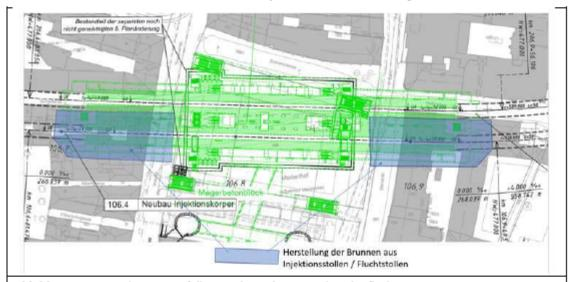
Abbildung 1: Lageplan zum Entfall von Bohrtätigkeiten an der Oberfläche
